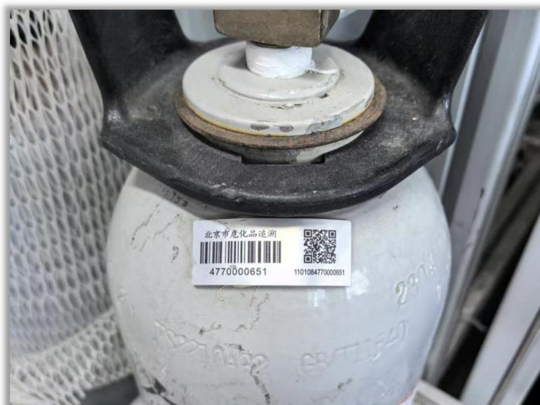
图 3 8L 规格气瓶肩部位《危化品追溯二维码》
