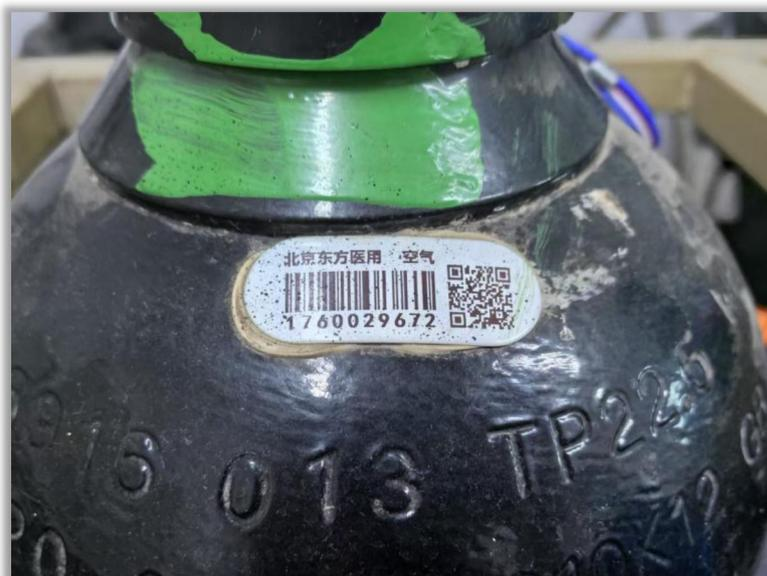
图 1 40L 规格气瓶肩部位《危化品追溯二维码》
